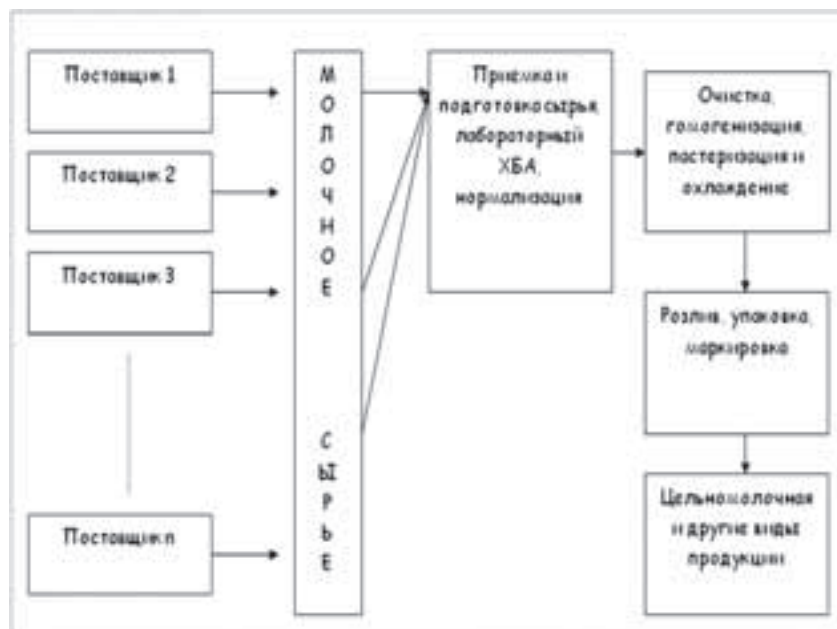
Рис. 1 – Структурная схема жизненного цикла производства молочной продукции
